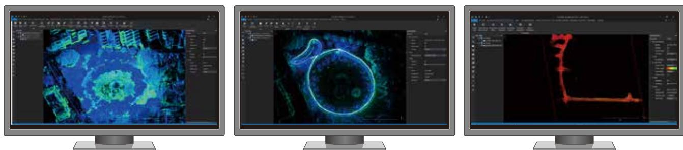
GoSLAM LidarWorksはRS100iで観測した点群サポートしている処理ソフトウェアシステムです。ソフトウェアには豊富な機能があり、操作がとても簡単です。データをさまざまな形式の点群でエクスポートできますので、現在ご使用の点群処理用のソフトウェアに取り込むことが可能です。点群データなどの一連の機能削除、ノイズ除去、点群の合成、セクションカット、そしてグリッドモデルの生成等の機能があります。
